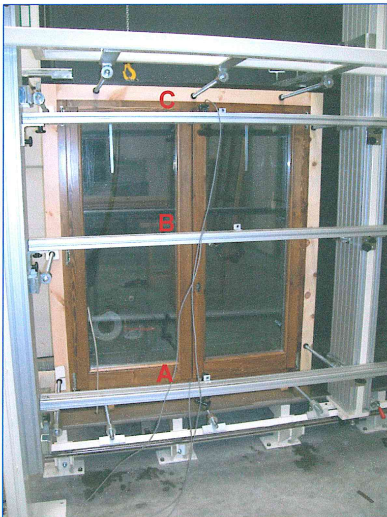
Fotografia del campione e dei sensori di spostamento durante la prova.
